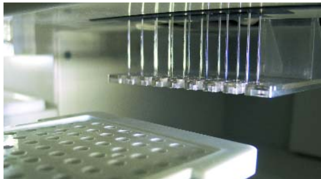
Kapillärerna - mycket smala rör - syns i högra delen av bilden.
